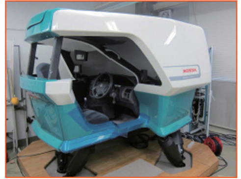
HONDA ドライビング・シミュレータ
