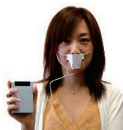
図6. フローセンサによるスクリーニング
